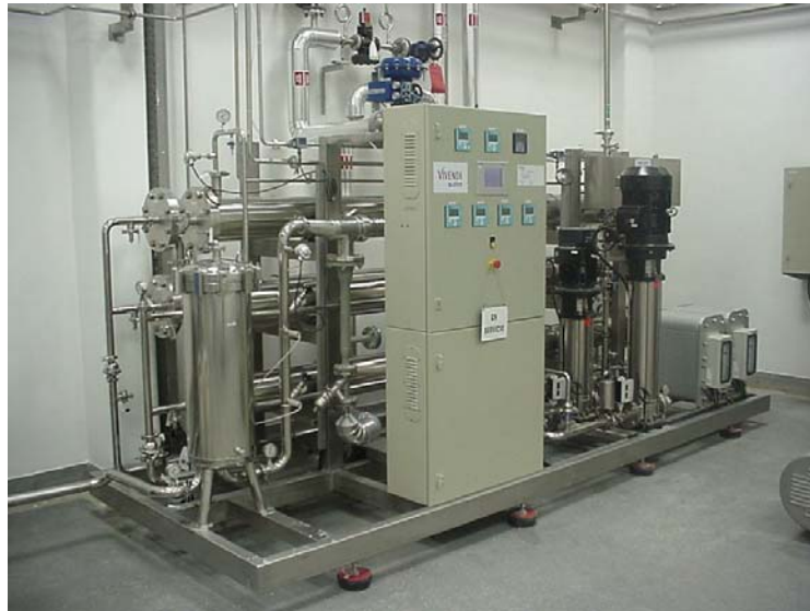
Foto 4. Sistema ORION ® de producción de agua purificada combinando ósmosis inversa y electrodesionización en continuo, sanitizable con agua caliente (producción 134 m 3 /día)
