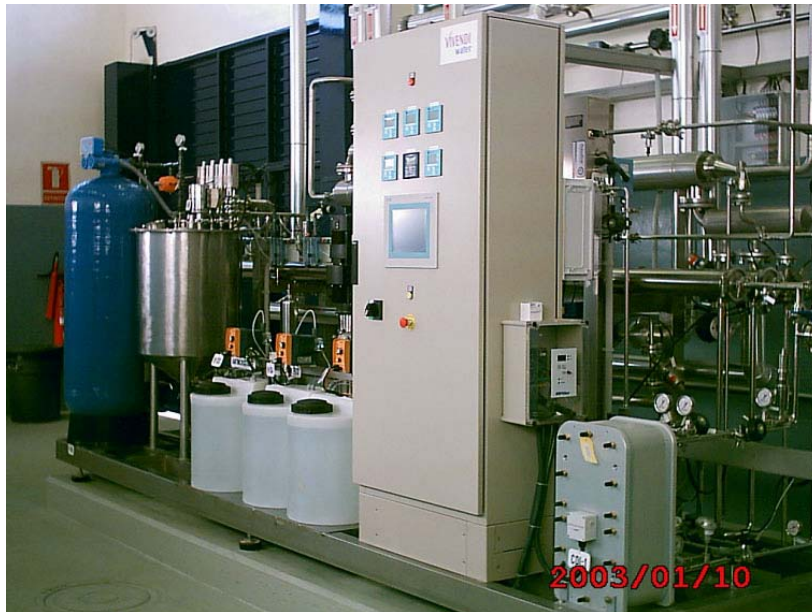
Foto 3 . Vista de un sistema de producción de agua purificada basado en ósmosis inversa y electrodesionización en continuo (producción 24 m 3 /día)
