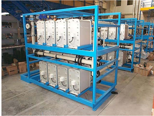
Foto 2 . Vista de un sistema modular de electrodesionización en continuo
