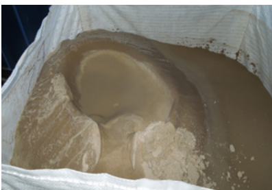
Drenaje y el secado de la estruvita producida utilizando un saco filtrante. Pruebas realizadas en la EDAR Braunschweig en Alemania, consiguiendo unos niveles de eficiencia en la eliminación del fósforo superiores al 85%
