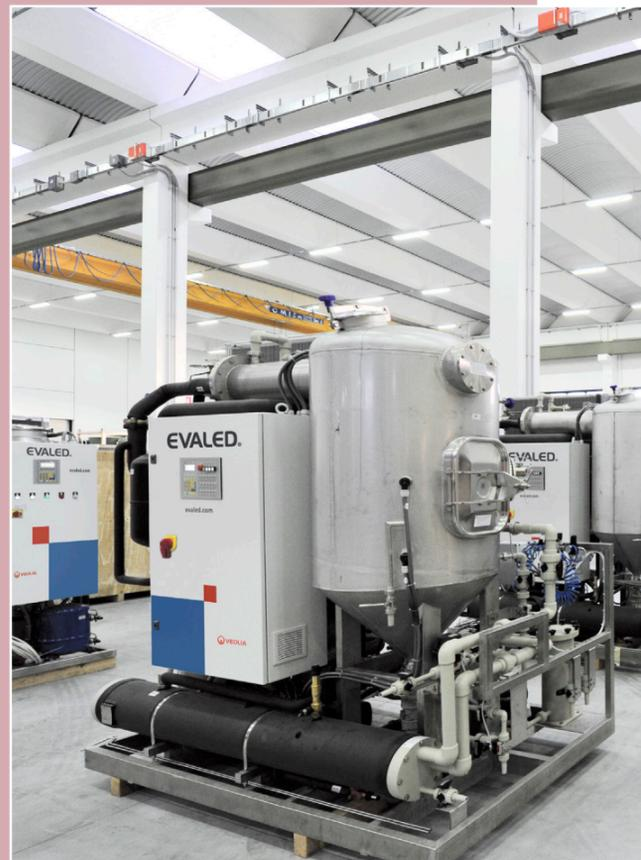
recircula el fluido, creando una película descendente en la zona de evaporación que favorece la destrucción de la espuma y reduce el ensuciamiento. La evaporación con compresión mecánica del vapor es el siste
