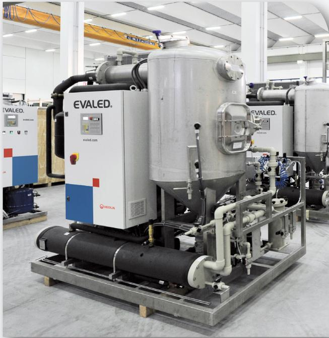
La evaporación de efluentes industriales es una de las tecnologías **más eficientes** en la separación de los contaminantes presentes en el agua.
