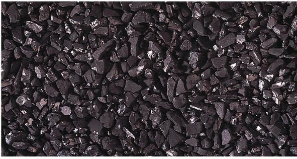
El carbón activo en polvo tiene una estructura microporosa que ofrece una superficie específica de adsorción muy alta para atrapar los contaminantes presentes en el agua y eliminarlos por adsorción. El uso del carbón activo en polvo en el proceso Actiflo® Carb permite una alta eficiencia en la eliminación de los contaminantes, consiguiendo un agua tratada de altísima calidad.
