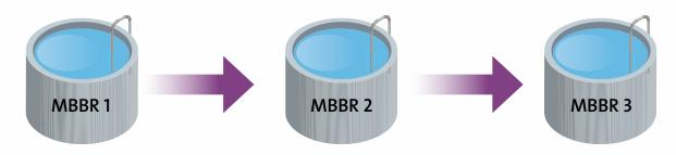
Bacterias que eliminan compuestos fácilmente biodegradables Bacterias que eliminan compuestos biodegradables de complejidad media Bacterias que eliminan compuestos difíciles de biodegradar
